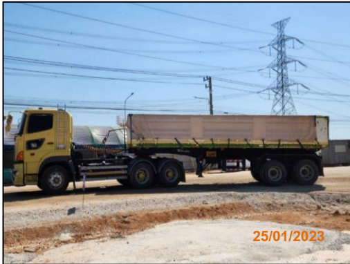
รูปที่ 2-7 รถบรรทุกปิดคลุมท้ายรถมิดชิดขณะขนส่งวัสดุก่อสร้าง
